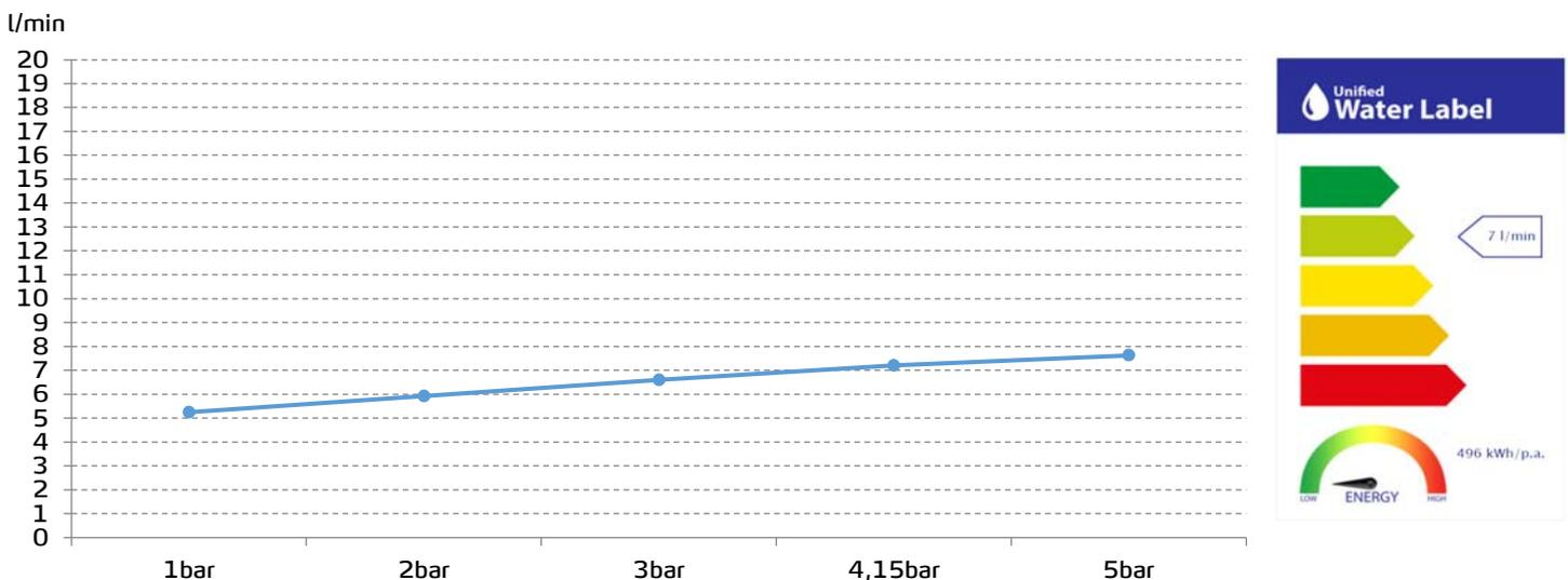
Datos medidos en posición de mezcla y máxima apertura
